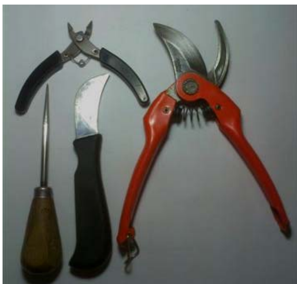
Obr. 36 Bočné elektrikárske kliešte, záhradnícke nožnice s tenkou reznou čepeľou, šidlo (je dobré na guľatej rúčke spraviť na boku plochy, potom sa nekotúľa a nepadá z pracovného stola), zahnutý nôž s neuzavierateľnou čepeľou.
